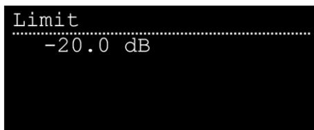
01) Gire el control **(16)** para ajustar el limitador. El rango de ajuste se encuentra entre -20 dB y 0 dB.
