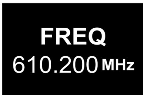
02) Pulse los **botones ARRIBA y ABAJO (26/25)** para establecer la frecuencia. El rango de ajuste de la frecuencia se encuentra entre 610–668 MHz.
