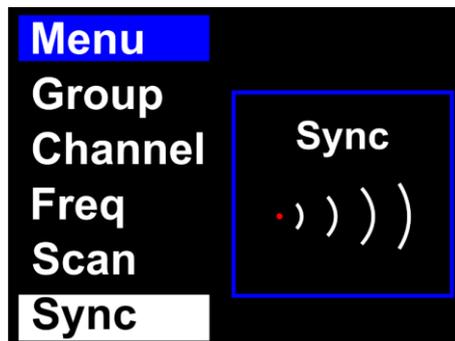
02) Pulse el **control (02)** para emparejar los dispositivos. El LED del **sensor IR (04)** del receptor parpadeará varias veces. Los dispositivos ya se habrán emparejado y estarán listos para utilizarse.
