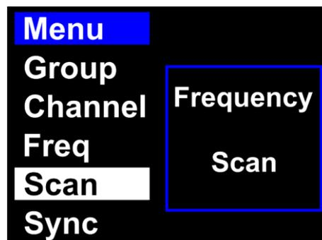
02) Pulse el **control (02)** para realizar un barrido del rango completo de frecuencias (610–668 MHz). Este proceso puede tardar hasta 2 minutos en completarse. Una vez finalizado el barrido podrá ver qué frecuencias ya están siendo utilizadas y usar las que no lo estén.
