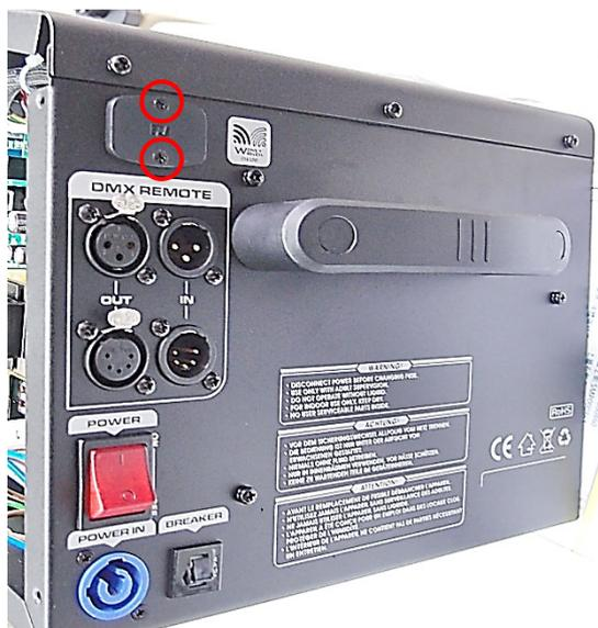
**Schritt 3. Entfernen Sie die Abdeckung.**
