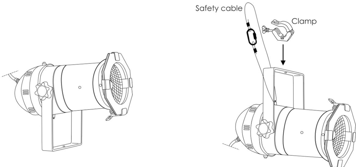
La unidad PAR 30 Warm-On-Dim se puede colocar en un suelo plano de escenario o instalar en cualquier tipo de truss mediante una abrazadera.
